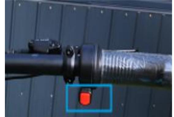
Schalter: Drücken Sie lange auf die Ein/Aus-Taste, um das Gerät ein-/auszuschalten; Beschleunigung: Drücken Sie die Stop&Start-Taste in der Nähe des rechten Gashebels, um zu starten, und verwenden Sie den Drehgashebel, um zu beschleunigen;
