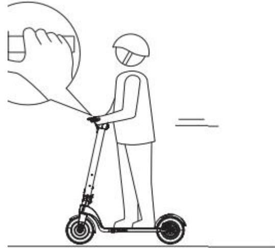
5 Beschleunigen Sie mit dem Drehgashebel. Fahren Sie nicht zu schnell.
